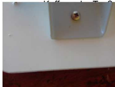
Bild 3: Nur ganze vier solcher winzigen Schrauben sollen eine billige Spanplatte halten? Und obendrein noch eine schwere Nähmaschine?
